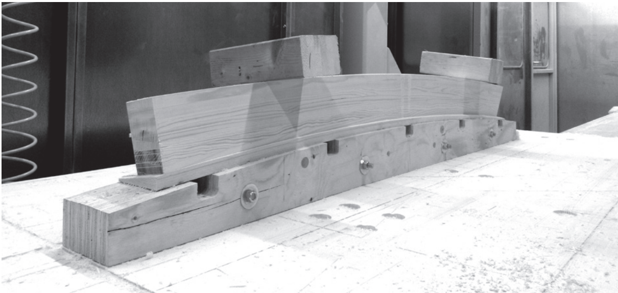
Cale vissée sur la poutre, avant l'usinage de l'intrados
