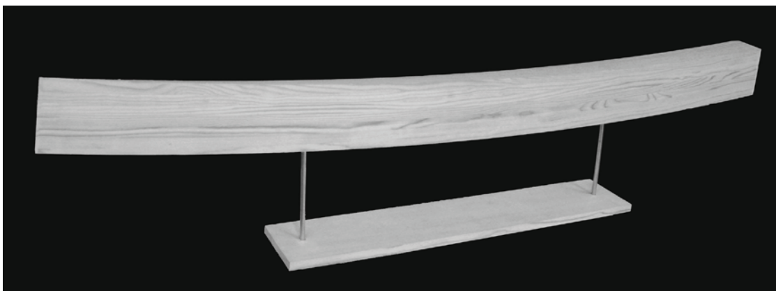
Poutre à double courbure réalisée
